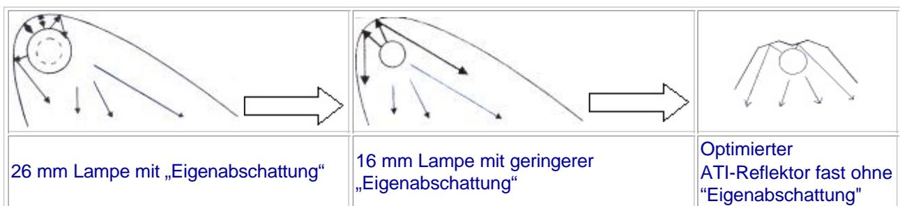
In einem zweiten Schritt wurde mit Hilfe von Computerprogrammen eine Reflektorform entwickelt, die fast keine Strahlen mehr auf die Lampe zurückwirft (keine Eigenabschattung) und somit die gesamte Lichtenergie gebündelt ins Aquarium lenkt. Bei der Wahl des Reflektormaterials wurde ebenfalls eines der hochwertigsten Materialien für Leuchtenbauer mit 95% Reflektionsrate gewählt (Standart ist hochglanzpoliertes Aluminium mit 86%
